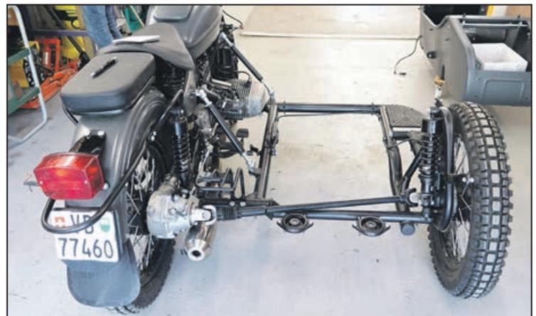
Le système à double cardans est couplé au moteur de la 3<sup>e</sup> roue, on remarque aussi les amortisseurs ab
